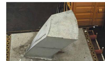
Ergebnis des ersten großformatigen Betongusses mit 3D gedruckter Schalung
